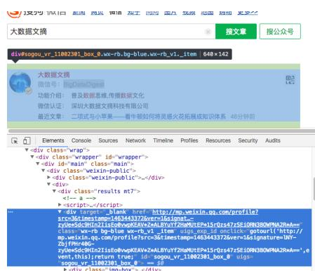
在Elements的标签处点右键选择：Copy->Copy XPath，就自动把xpath路径拷贝到剪切板了
