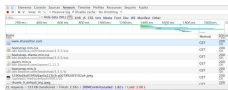
Request URL展示了要请求的链接，Request Method是请求方法：GET（HTTP协议中还有POST、HEAD等方法），Status Code是返回码（200表示正常返回页面），Remote Address是服务器的ip:port（其中的ip就是通过dns服务根据域名获取到的ip地址，port默认都是80端口）
