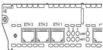
如图 2 所示为 10Base-T 网 RJ-45 端口，而图 3 所示的为 10/100Base-TX 网 RJ-45 端口。其实这两种 RJ-45 端口仅就端口本身而言是完全一样的，但端口中对应的网络电路结构是不同的，所以也不能随便接。
