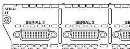
这种端口主要是用于连接目前应用非常广泛的 DDN、帧中继（Frame Relay）、X.25、PSTN（模拟电话线路）等网络连接模式。在企业网之间有时也通过 DDN 或 X.25 等广域网连接技术进行专线连接。这种同步端口一般要求速率非常高，因为一般来说通过这种端口所连接的网络的两端都要求实时同步。
