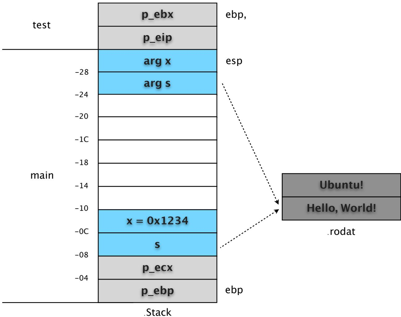
`main` 中的 `call` 指令会先将 `eip` 的值入栈，以便函数完成时可以恢复调用位置。然后才是跳转到 `test` 函数地址入口。因此我们在 `test` 中设置的断点(0x080483c7)中断时，`test` 堆栈帧中就有了 `p_eip` 和 `p_ebp` 两个数据。
