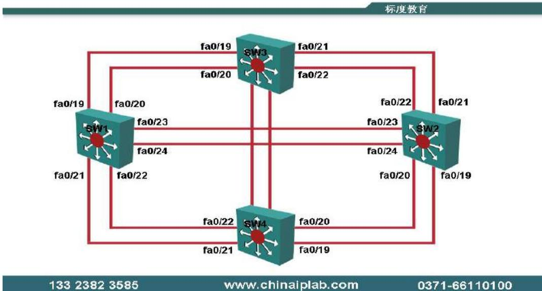
本实验拓扑由四台 Cisco Catalyst 3550 交换机组成，采取全互连的方式连接，可以完成 CCNP 所有交换实验。
